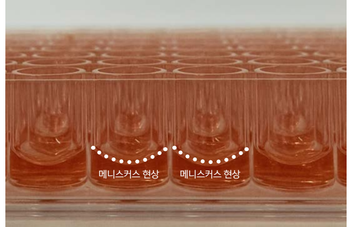
[그림] 96웰플레이트 내부 용액 표면의 메니스커스 형성 모습
